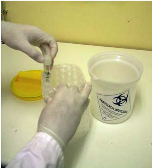
Ejemplo de contenedor secundario homologado con contenedor primario (tubo con muestra) y protección anti choque
